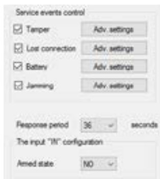
FIGURA 22. Menu di impostazione delle uscite di servizio sulla schermata "Radio zones"
