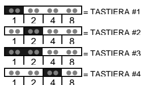
Figura 10 - Programmazione dei ponticelli per indirizzo tastiere
