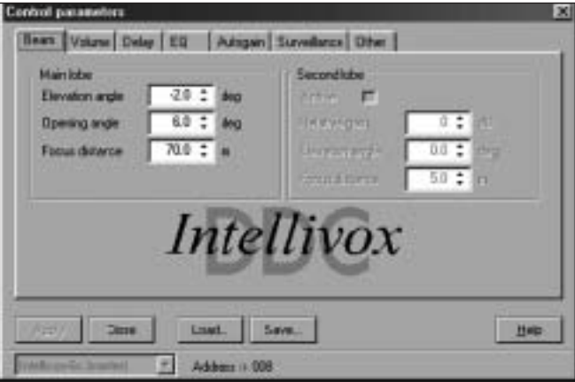
Fig 3.1: Parametri fascio sonoro Intellivox
