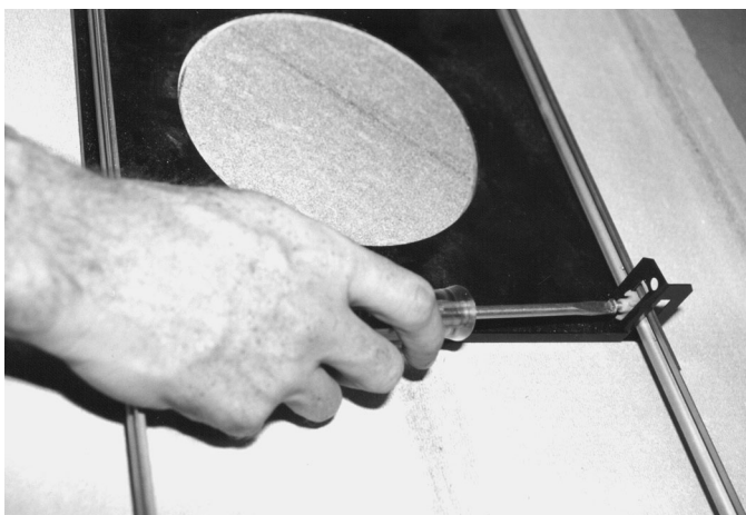
Immagine 4.4 Serraggio della vite di sicurezza staffa
