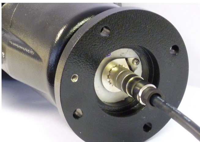
Immagine 5.10 Vista del connettore del cavo composito collegato ad una telecamera MIC serie 500
