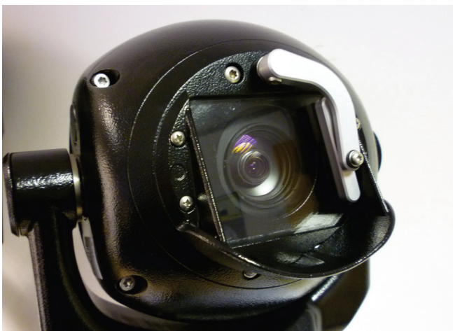
Immagine 5.8 Schermatura per la pioggia capovolta
