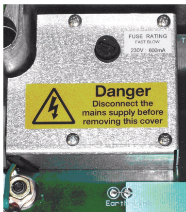
Immagine 4.3 Schermatura dell'estremità a monte di ingresso dell'alta tensione inserita nella custodia della PSU
