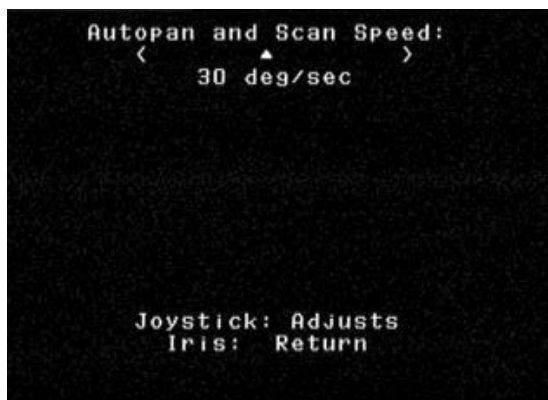
Figura 6 Regolazione della velocità di panoramica/scansione in automatico
