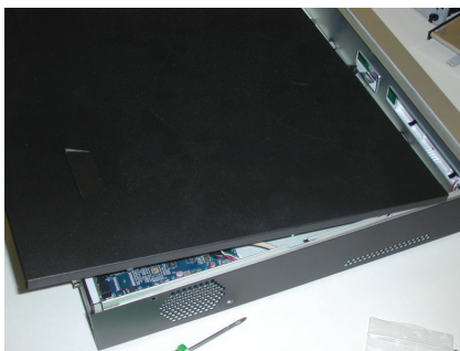
Figura 5.14: Installazione di un DVD nell'unità DIVAR 5000
