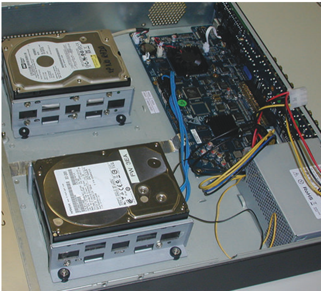
Figura 5.10: Installazione dei dischi rigidi 3 e 4
