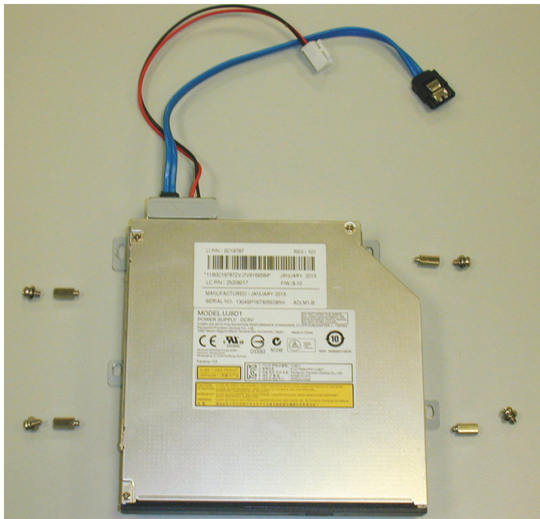
Figura 5.13: Installazione dei componenti di un DVD (unità DIVAR 5000)
