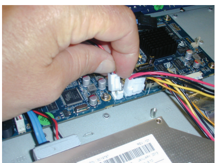
Figura 5.12: Installazione di un DVD nell'unità DIVAR 3000
