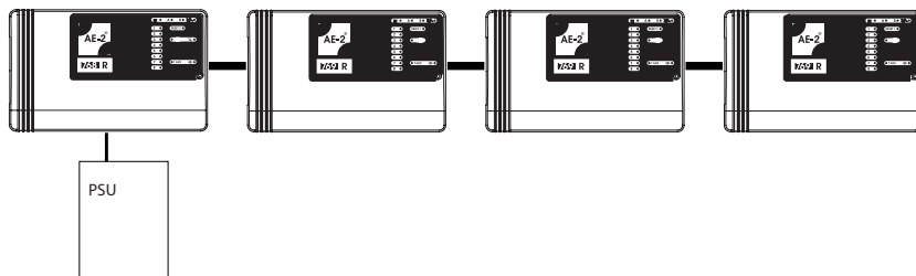
Figura 11. Collegamento delle Espansioni.
