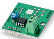
EA2 - Modulo uscita audio con amplificatore
