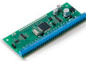
EPGM1 - Modulo di espansione zone cablate e uscita PGM
