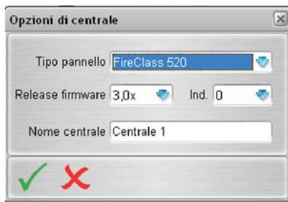
Figura 21 Finestra Dettagli Centrale
