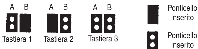
Figura 2.5 Configurazione dei ponticelli della tastiera
