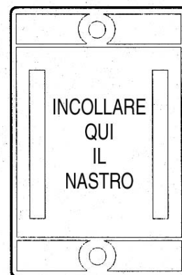
Figura 2. Posizione del nastro adesivo sul retro del supporto
