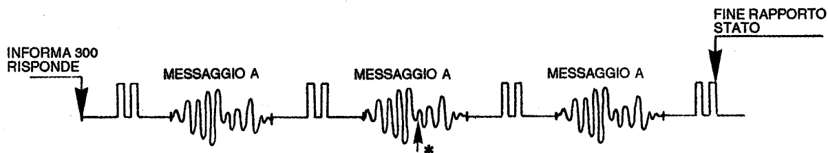
RISPOSTA AD INTERROGAZIONE QUANDO NON E' STATO ATTIVATO ALCUN CANALE, LA BATTERIA E' O.K. ED IL SISTEMA E' INSERITO.
