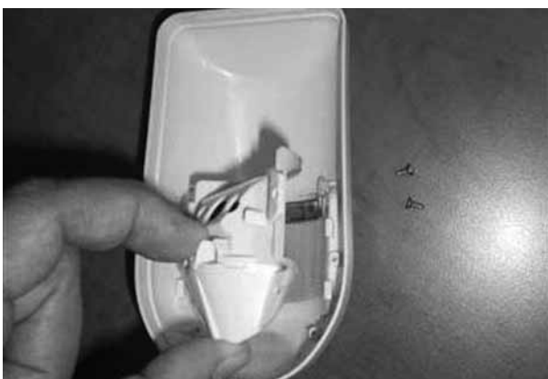
4. Estrai il coperchio delle centrali
