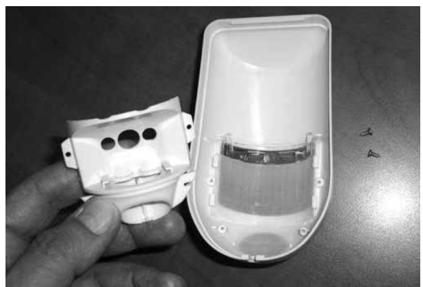
4. Estrai il coperchio delle centrali
