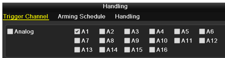
Figura 8.3 Impostazione delle Camere Allarmate dal Motion Detection
