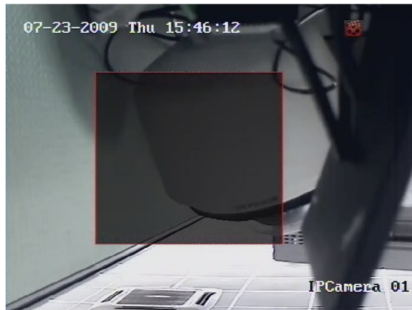
Figura 17. Impostazione dell'Area di Rivelamento delle Anomalie Video
