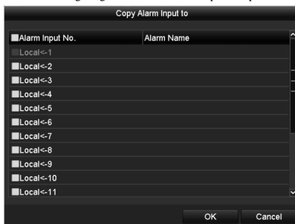
Figure 8. 8 Copia delle impostazioni di un ingresso allarme
