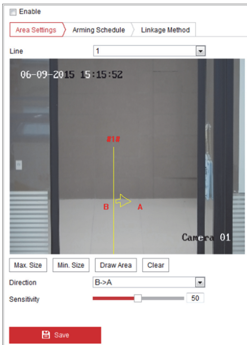
Figura 10-20 Rilevamento di attraversamento di una linea
