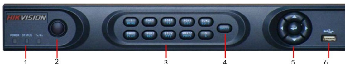
Figura1. Pannello frontale del NVR/HVR serie DS-7604
