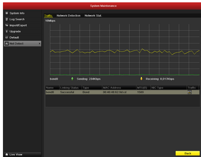
Figura 9.24 Interfaccia Traffico di Rete
