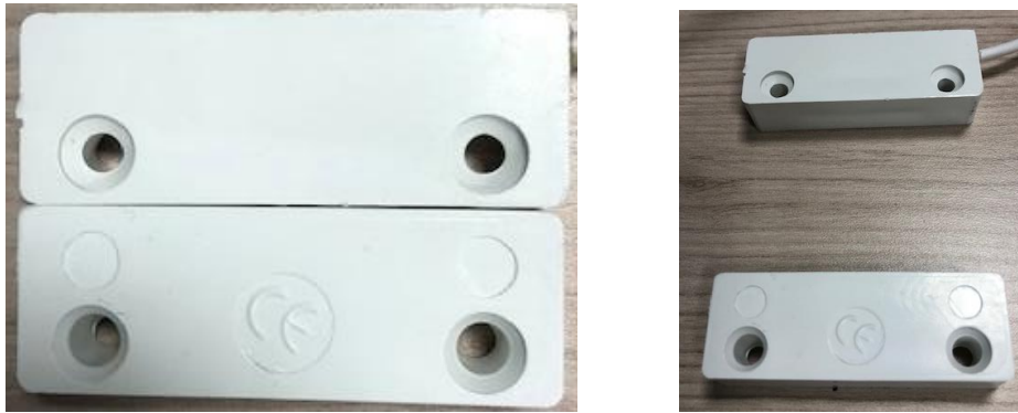
Figura 2: esempio di contatto magnetico; a sinistra la posizione “chiusa” (segnale NO con transito di corrente), a destra la posizione “aperta” (segnale NC con assenza di transito corrente). La logica di programmazione del controllore deve tenere conto di questa “inversione” e lo stato standard (porta chiusa) è pertanto NO.
