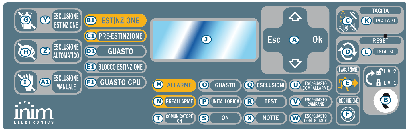
Figura 1 - Pannello frontale della centrale
