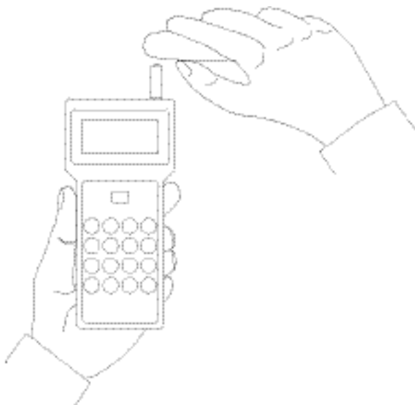
Fig. 2 : Ricezione ottica del codice di un trasmettitore.
