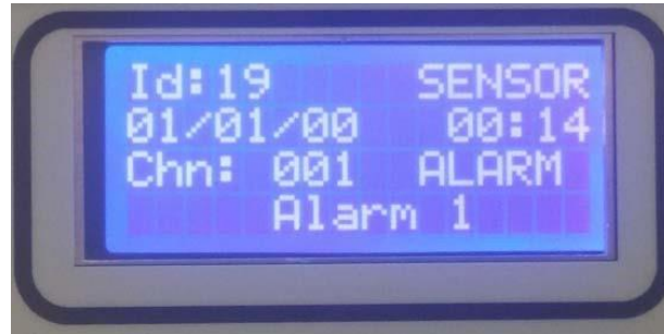
Fig. 3-5) Dettagli evento di Allarme 1
