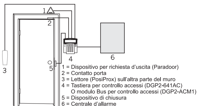
Figura 14-1: Installazione Tipica del Controllo Accessi
