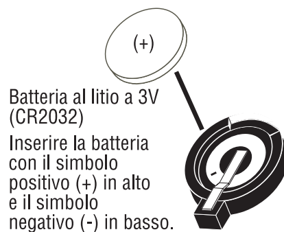
Figura 11: Cambio della batteria dell'orologio RTC
