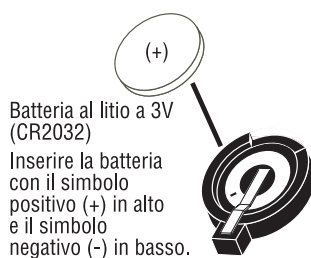
Figura 11: Cambio della batteria dell'orologio RTC
