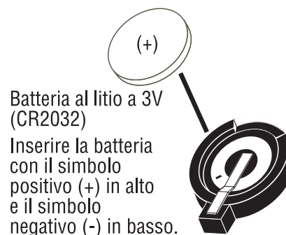
Figura 11: Cambio della batteria dell'orologio RTC
