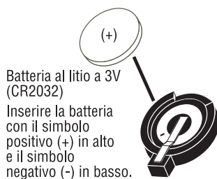
Figura 11: Cambio della batteria dell'orologio RTC
