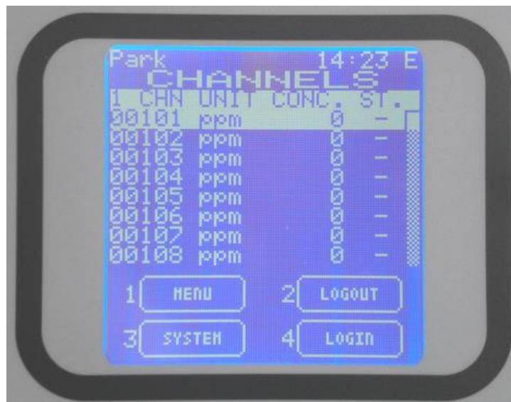
Fig. 3.7 b) Stato normale con la E di Engineer nell'angolo in alto a destra.
