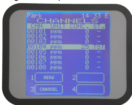
Figura 41) Videata con canali in Test
