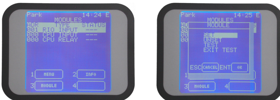
Figura 36) Videata Moduli ed opzioni disponibili premendo 3-Modulo
