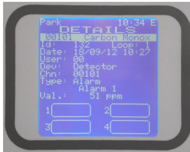
Fig. 3.2.1.c) Dettagli evento di Allarme 1
