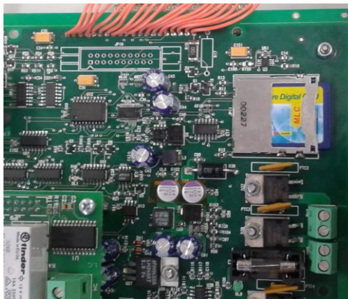
Fig. 4.4.1 f) Posizione scheda SD nella centrale
