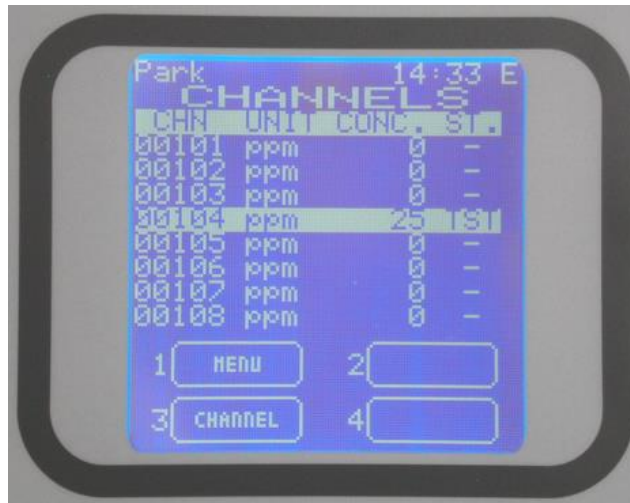
Fig. 3.8.3 b) Videata con canali in Test
